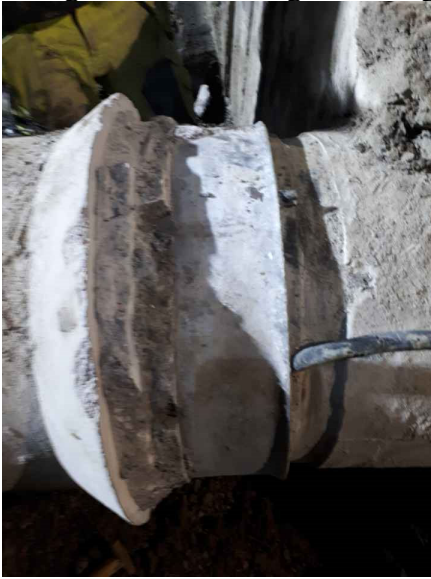
Figur 2:1 Bonnamuff med betongen avlägsnad.
