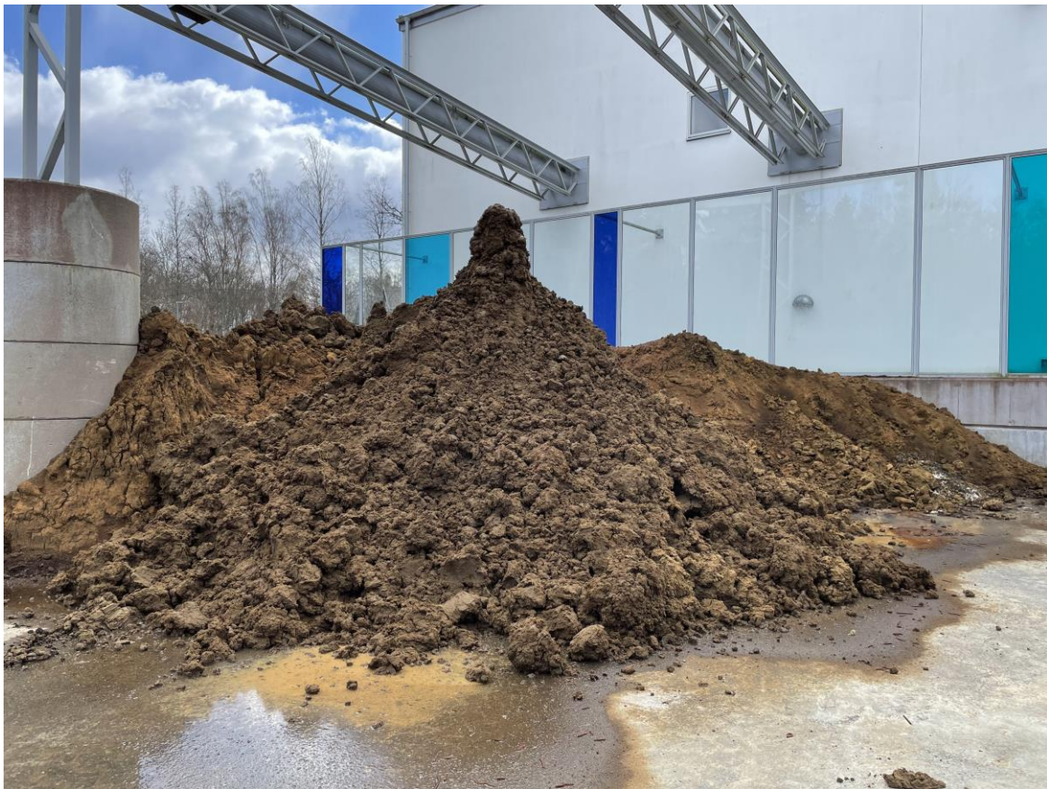
Vattenverksslam som har avattnats vid Görvälnverket (foto: Frida Hugg)
