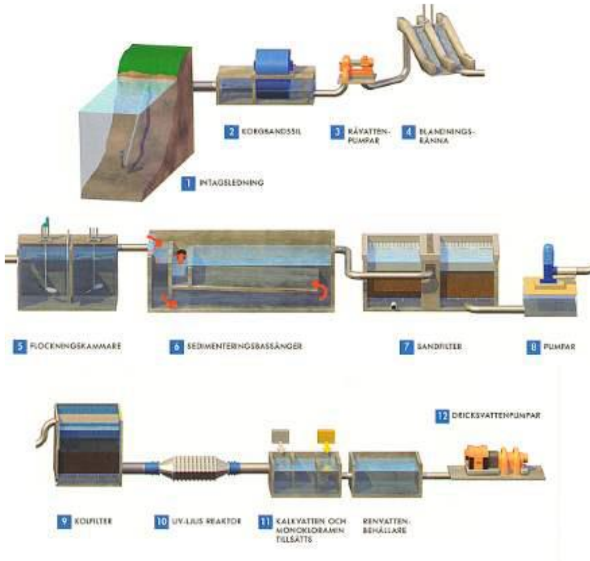
Figur 1: Schematisk bild över Norrvattens reningsprocess på Görvålverket [3]
